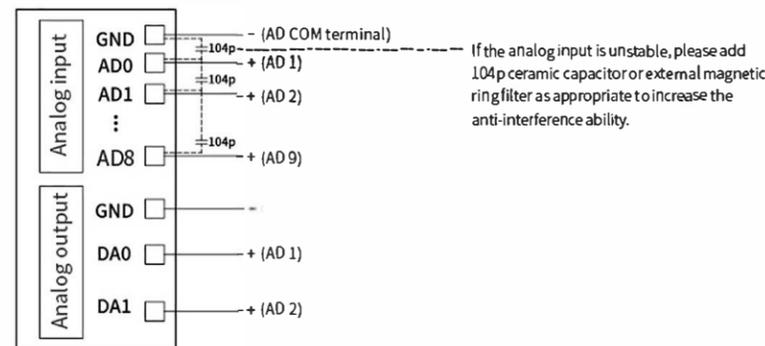
Figure 13 PLC analog wiring
